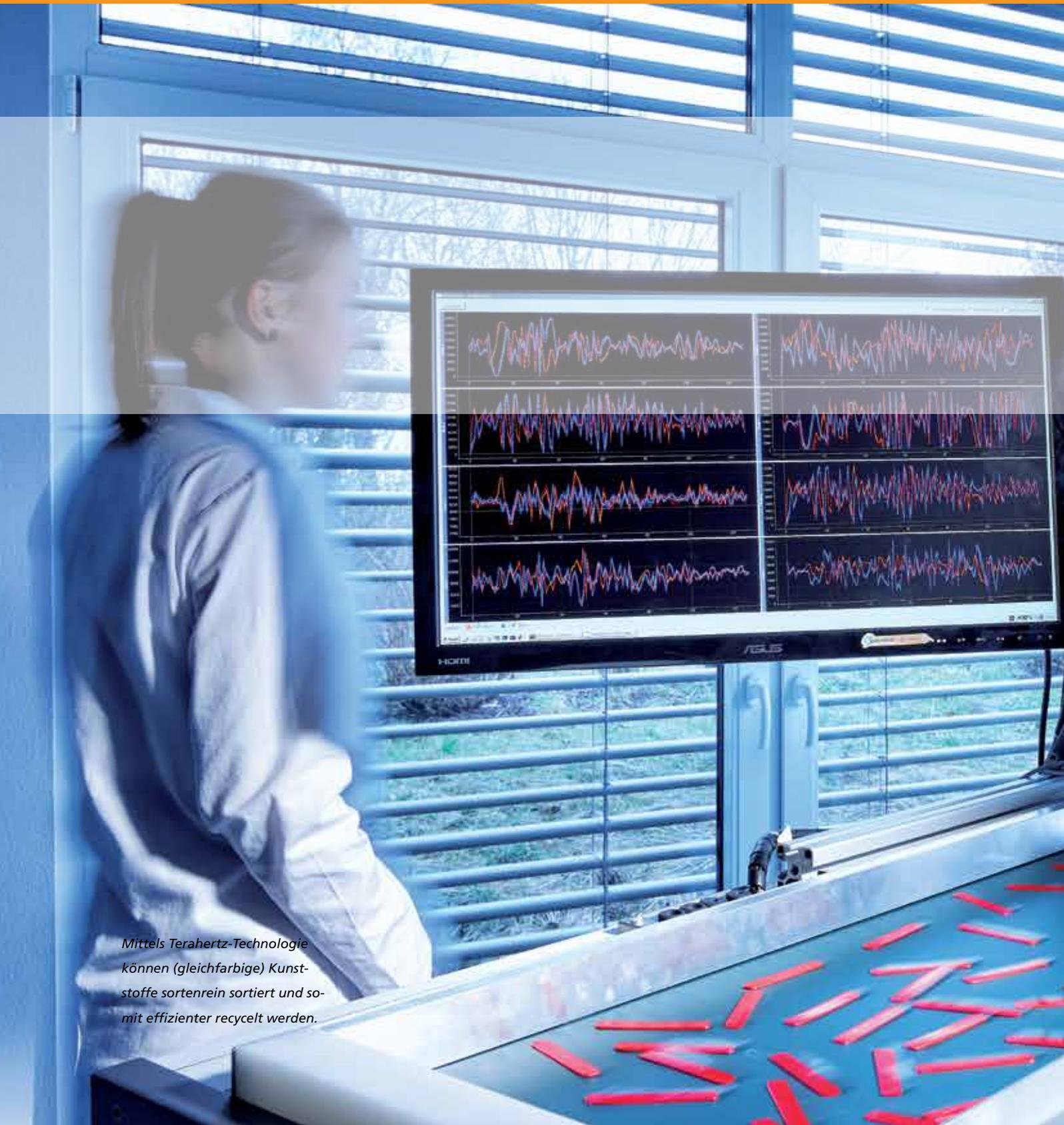
*Mittels Terahertz-Technologie können (gleichfarbige) Kunststoffe sortenrein sortiert und somit effizienter recycelt werden.*
