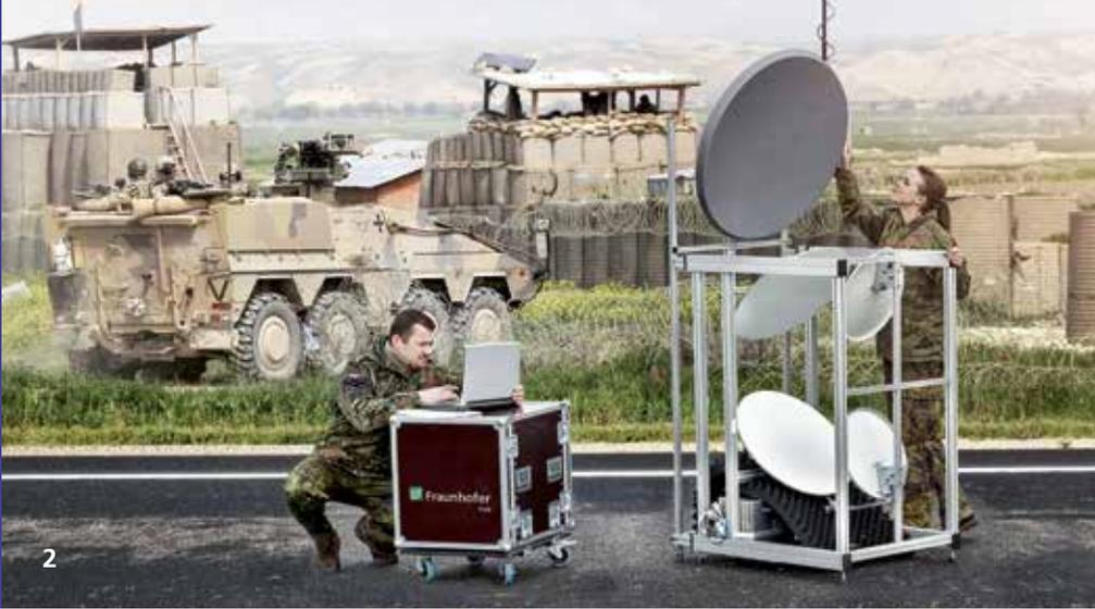
Das Herzstück des passiven Scanners wird vom Fraunhofer IAF in Freiburg erforscht: Ein mehrkanaliger 300 GHz-Empfänger sorgt für gesteigerte räumliche Auflösung. Das Fraunhofer FHR entwirft die Imager-Optik und die Signalverarbeitung, um daraus ein vollständiges System herzustellen.
