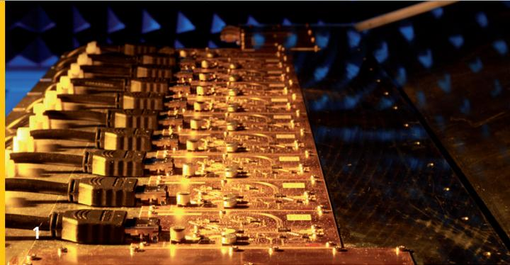
1 Die Sende-/Empfangsmodule eines funktionstüchtigen Labormusters der aktiven Gruppenantenne mit hochintegrierten Mixed-Signal-Schaltungen auf Silizium-Germanium (SiGe) Basis.
